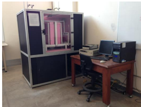
Fig. 5 TR-02- Medidor de propiedades térmicas mediana escala
