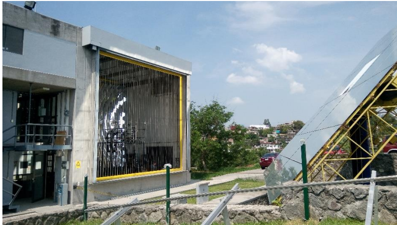
Figura 2. Horno solar del IER-UNAM en operación como alternativa en la síntesis de nanomateriales cerámicos.
