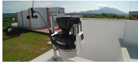
Figura 3. sensores de radiación global y UV montados en la estación DAVIS Vantage Pro 2 en el CENITT en la ciudad de Tepic, Nayarit.
