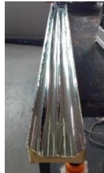
Figura 4. Colector CPC construido a partir de un molde 3D
