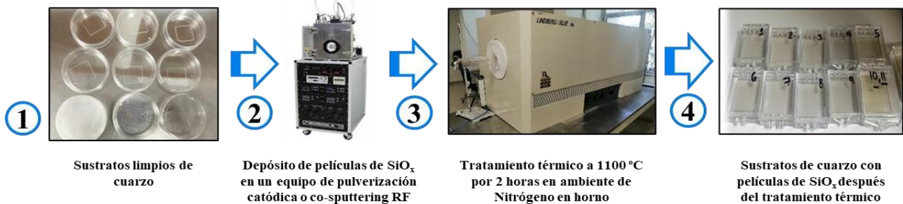
Figura 2. Procedimiento para el depósito de películas de \text{SiO}_x por pulverización catódica sobre sustratos de cuarzo.
