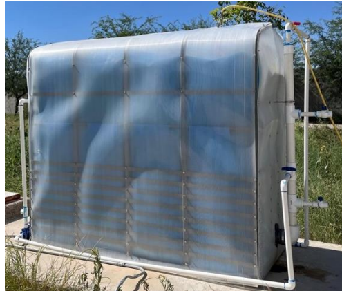
Figura 02. Vista lateral del biodigestor terminado.
