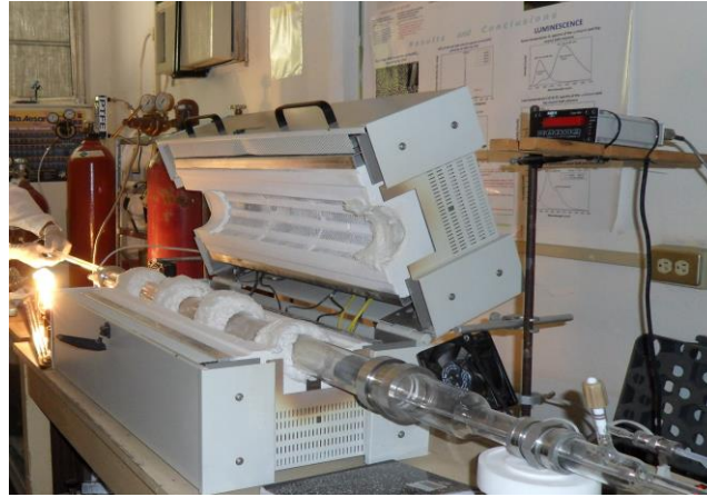
Figura 4. Reactor tubular de cuarzo para depósito por vapores químicos utilizado en esta investigación.
