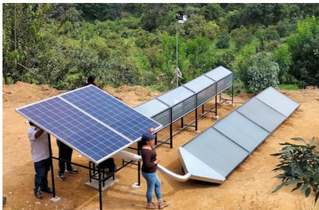
Figura 3 a) Secador solar tipo túnel ventilador fotovoltaico b) secador solar tipo túnel ventilador eléctrico
