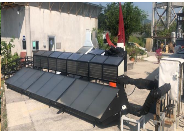
Figura 3 a) Secador solar tipo túnel ventilador fotovoltaico b) secador solar tipo túnel ventilador eléctrico
