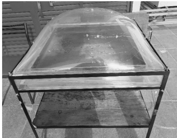
Figura 1. Destilador solar semiesférico empleado para las pruebas experimentales.
