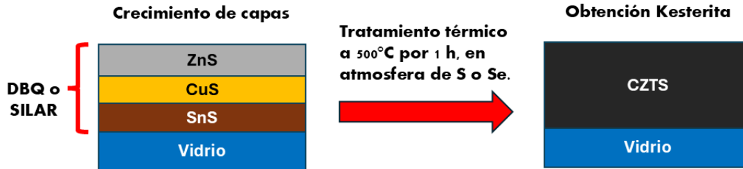
Figura 1.- Diagrama esquemático para formación de la fase cuaternaria CZTS por DBQ o SILAR.
