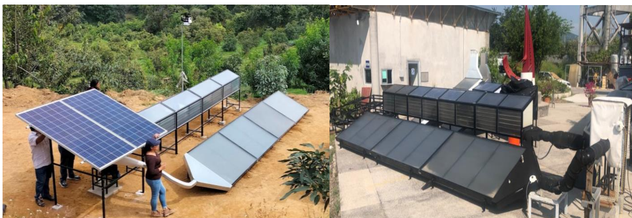
Figura 3 a) Secador solar tipo túnel ventilador fotovoltaico b) secador solar tipo túnel ventilador eléctrico
