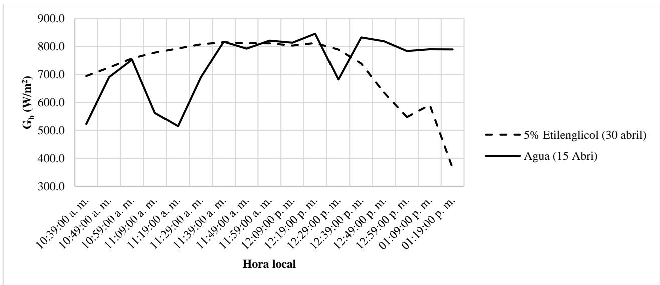
Figura 2, Comparativa de la irradiación directa durante las pruebas.
