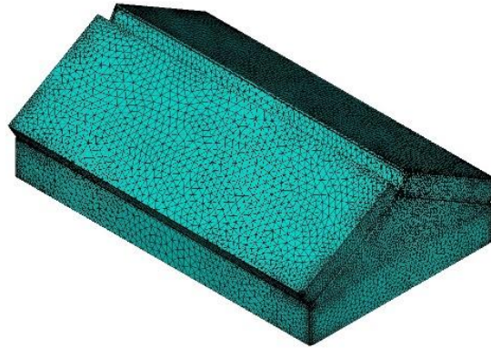
Figura 2. Mallado generado con el software CFD para el destilador solar.
