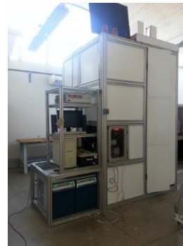
Fig. 4 TR-01 Medidor de propiedades térmicas semiautomático
