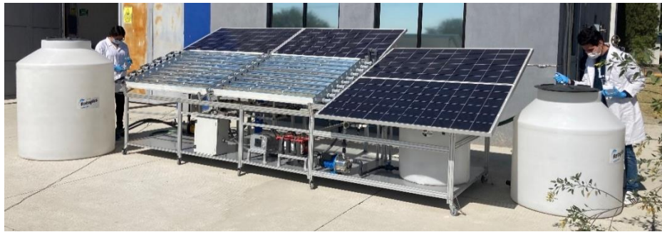
Figura 5. Prototipo solar de potabilización de agua.
