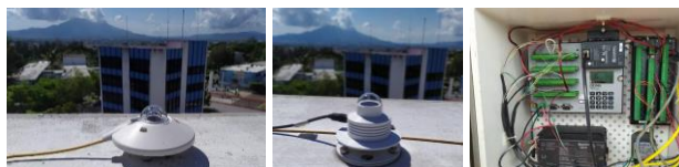
Figura 2. a) piranómetro CMP 11; b) biómetro 501A; c) sistema de adquisición de datos CR3000. Instrumentos instalados en la estación de la Red Solarimétrica Mexicana en la Universidad Autónoma de Nayarit.
